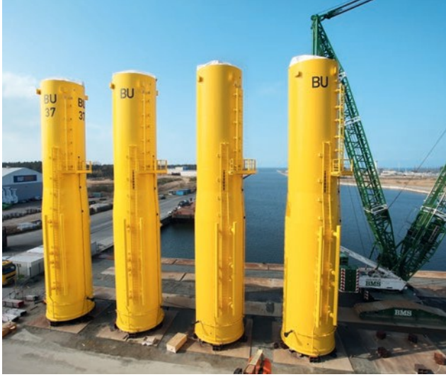
Переходные части Ветряная электростанция Бутендиэк
